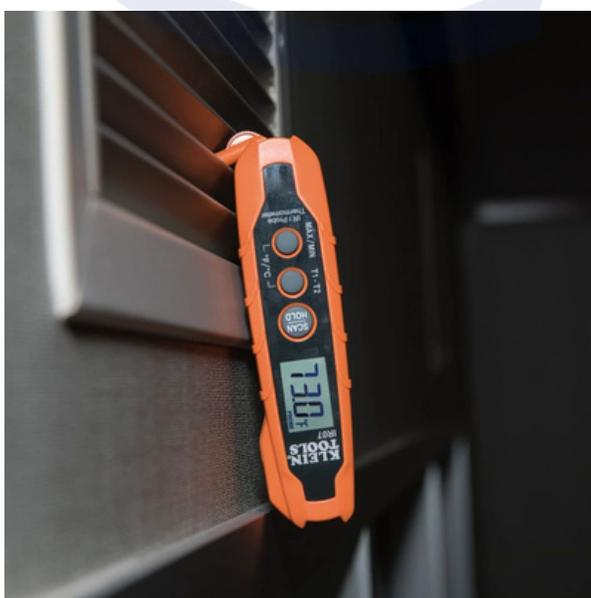
Mide las rejillas de ventilación y las temperaturas del conducto utilizando una sonda de temperatura con gancho para colgar manos libres.
