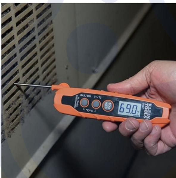
La sonda mide con precisión las temperaturas del aire, los líquidos y las superficies, de -40 a 572 °F (-40 a 300 °C). La sonda de temperatura también puede medir las temperaturas del líquido.
