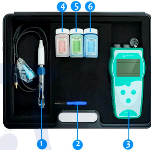
1. Electrodo pH/Temp. punta de lanza LabSen 763
