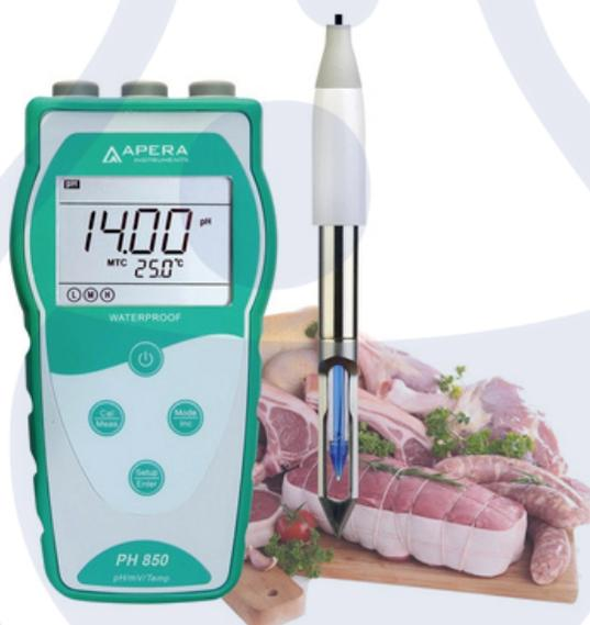
Diseñado para la medición profesional del pH de carnes y productos cárnicos con la ayuda del electrodo de pH de punta de lanza LabSen 763.
