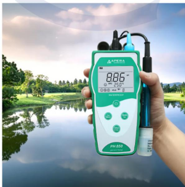
La estructura resistente al agua IP57 hace que el medidor sea ideal para su uso en entornos hostiles. La funda de goma protege el instrumento contra impactos generales y le proporciona un agarre firme.
